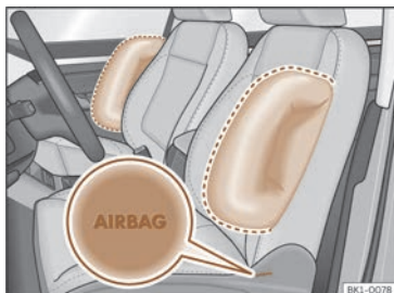
Fig. 47 Airbag latéral sur le siège du conducteur et du passager avant.
