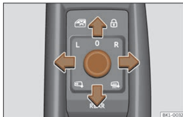
Fig. 110 Détail de la portière du conducteur : commande du rétroviseur extérieur.
