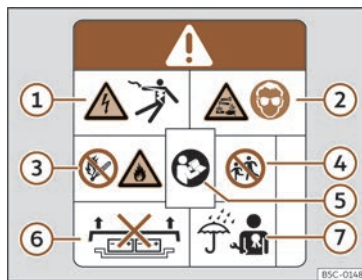
Fig. 64 Étiquette d'avertissement sur la batterie à haute tension.
