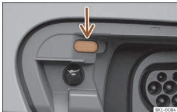
Fig. 18 Indicateur LED de l'opération de charge.
