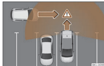
Fig. 154 Représentation schématique de l'assistant de sortie de stationnement : zone surveillée autour du véhicule qui sort du stationnement.
