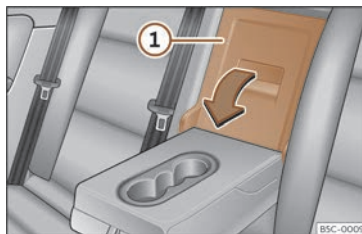
Fig. 175 Dans le dossier de la banquette arrière : ouverture de la trappe de chargement.
