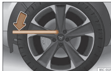
Fig. 200 Changement de roue : desserrer les boulons de la roue.
