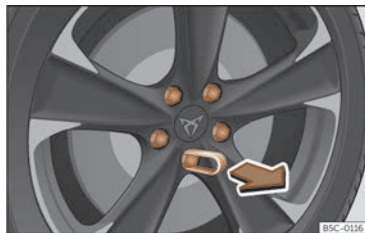
Fig. 198 Roue : boulons de la roue avec capuchons.
