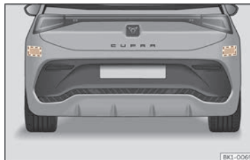
Fig. 121 Vue arrière du véhicule : zones des capteurs radar.
