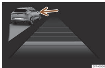
Fig. 127 Sur l'écran du combiné d'instruments : ACC activé, véhicule circulant à gauche détecté.
