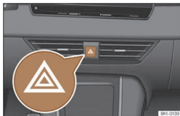
Fig. 60 Combiné d'instruments : interrupteur des feux de détresse.
