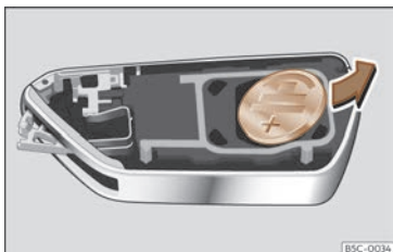
Fig. 81 Clé du véhicule : retirer la pile.
