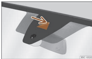
Fig. 120 Sur le pare-brise : aire de champ visuel de l'assistant de maintien de voie.
