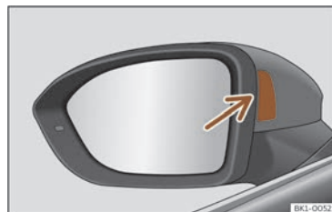
Fig. 156 Sur le rétroviseur : témoin d'alerte.
