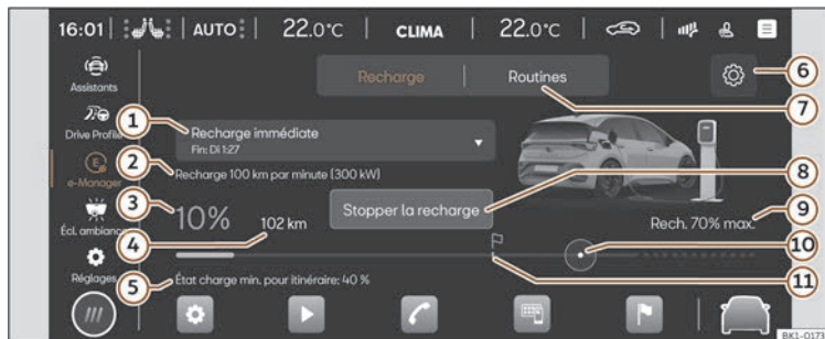
Fig. 74 Sur le système d'infodivertissement : menu Gestionnaire d'énergie dans les réglages du véhicule.
