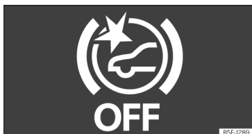
Fig. 132 Sur l'écran du combiné d'instruments : indication du Front Assist désactivé.
