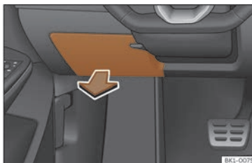
Fig. 185 Sous le combiné d'instruments côté conducteur : couvercle de la boîte à fusibles.
