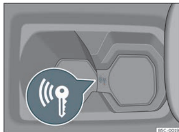
Fig. 154 Sur la console centrale : démarrage d'urgence.
