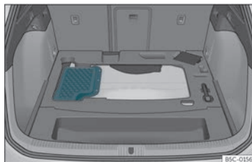
Fig. 222 Emplacement de la batterie dans le coffre à bagages
