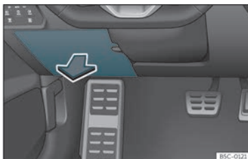
Fig. 51 Sur le tableau de bord côté conducteur : cache du boîtier de fusibles.
