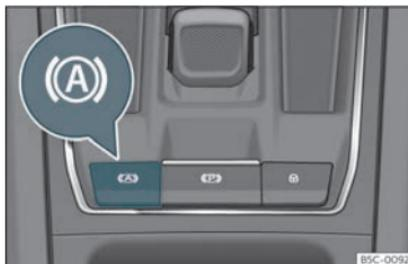
**Fig. 173** Sur la partie inférieure de la console centrale : touche de fonction Auto Hold.
