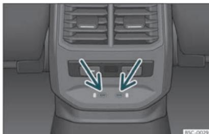
Fig. 137 Partie arrière de la console centrale : connecteurs USB avec fonction de prise de courant.
