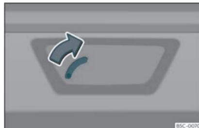
Fig. 85 Détail du coffre à bagages : déverrouillage d'urgence.
