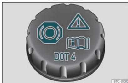
Fig. 208 Compartiment-moteur : bouchon du réservoir de liquide de frein.
