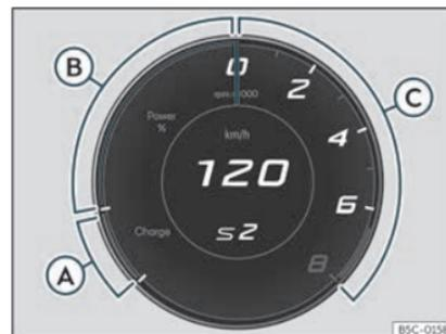
Fig. 57 Combiné d'instruments numérique : Powermeter (vue Cupra)
