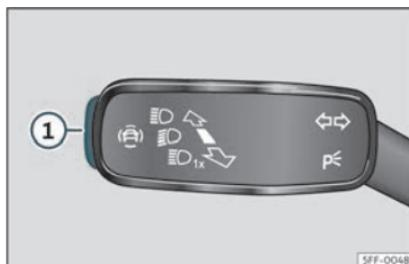
Fig. 61 Sur le levier des clignotants et des feux de route : touche pour les systèmes d'assistance à la conduite (en fonction des versions).
