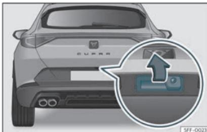
Fig. 81 Hayon : ouverture de l'extérieur.
