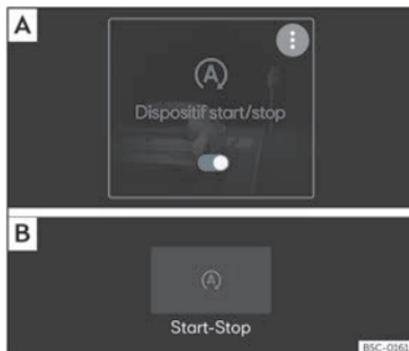
**Fig. 140** Sur l'écran du système d'infodivertissement : système Start-Stop activé. [A] Vue dans le menu principal. [B] Vue avec le système d'infodivertissement éteint.
