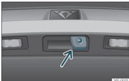
**Fig. 150** Sur la poignée du hayon : emplacement de la caméra de l'assistant de marche arrière.
