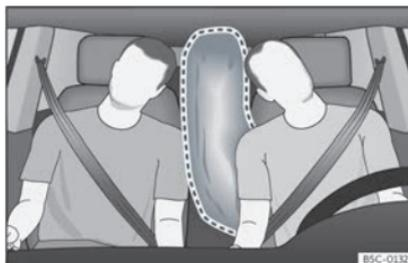
Fig. 20 Airbag central complètement gonflé (zone de déploiement).
