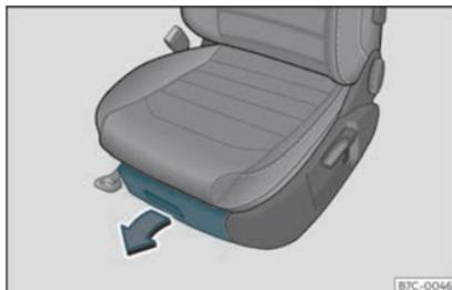
Fig. 123 Rangements sous les sièges avant.
