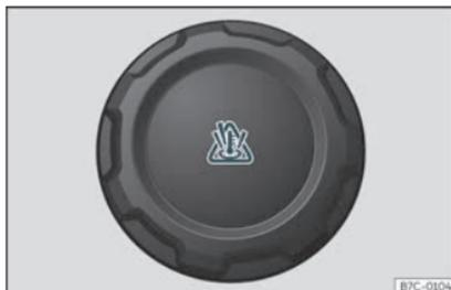
**Fig. 207** Compartiment-moteur : bouchon du vase d'expansion du liquide de refroidissement.
