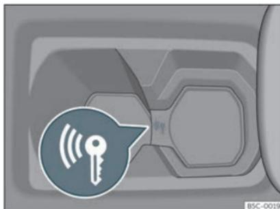
**Fig. 139** Sur la console centrale : démarrage d'urgence.
