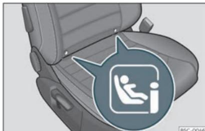
**Fig. 28** Siège passager avant : anneaux de fixation ISOFIX/i-Size.
