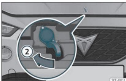
**Fig. 201** Levier sous le capot.
