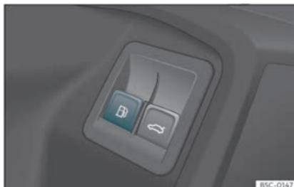
**Fig. 196** Porte du conducteur : Déverrouillage de la trappe du réservoir.
