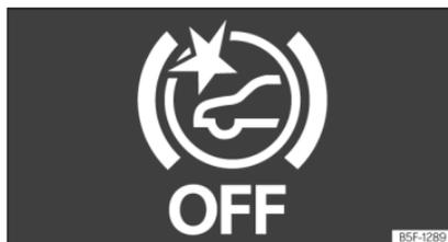
**Fig. 155** Sur l'écran du combiné d'instruments : indication de Front Assist désactivé.
