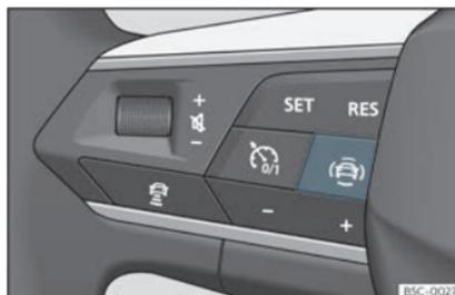
Fig. 62 Partie gauche du volant multifonction : touche pour les systèmes d'assistance à la conduite (en fonction des versions).
