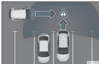
Fig. 169 Représentation schématique de l'assistant de sortie de stationnement : zone surveillée autour du véhicule sortant de stationnement.
