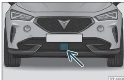
**Fig. 145** Au niveau du pare-chocs avant : : capteur radar.
