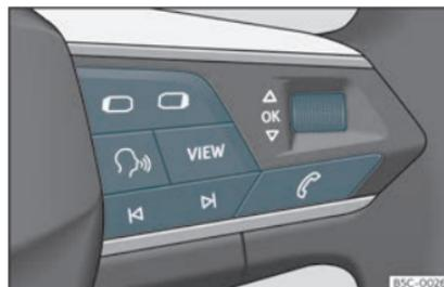
**Fig. 60** Partie droite du volant multifonction : touches permettant d'utiliser les menus et les messages d'information du combiné d'instruments (selon les versions).
