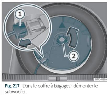
**Fig. 217** Dans le coffre à bagages : démonter le subwoofer.
