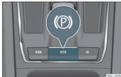
Fig. 172 Sur la partie inférieure de la console centrale : touche du frein de stationnement électronique.
