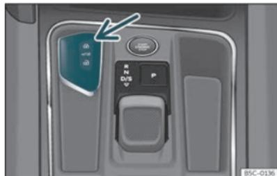
Fig. 70 Console centrale : Logement de la clé du véhicule.
