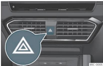
Fig. 91 Planche de bord : commande des feux de détresse.
