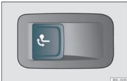
**Fig. 185** Sur le côté gauche du coffre à bagages : touche de déverrouillage du crochet d'attelage.
