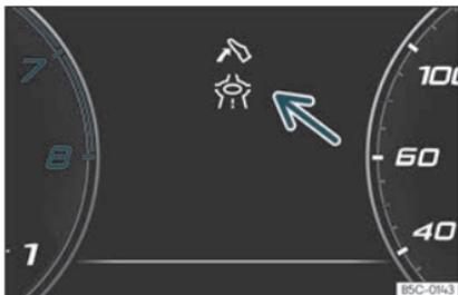
**Fig. 55** Indication de l'assistance pour une conduite écologique (représentation schématique).
