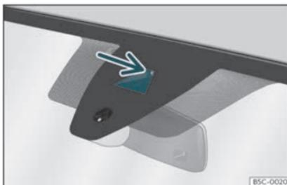
**Fig. 147** Sur le pare-brise : fenêtre de l'assistant de maintien de voie.
