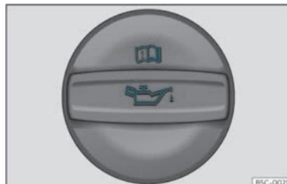
Fig. 204 Dans le compartiment-moteur : bouchon de l'orifice de remplissage d'huile moteur.
