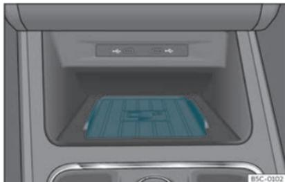
**Fig. 135** Sur la console centrale : logement pour la connexion du téléphone mobile.
