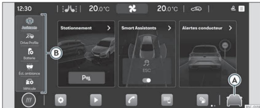
Fig. 66 Représentation schématique : Assistants d'aide et réglages du véhicule
