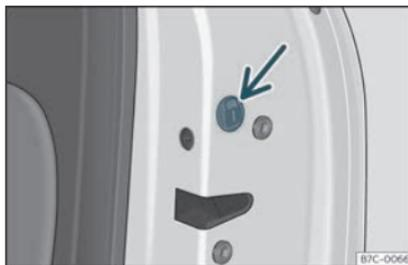
Fig. 79 Verrouillage d'urgence de la porte.
