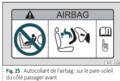
Fig. 25 Autocollant de l'airbag : sur le pare-soleil du côté passager avant
