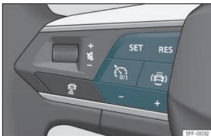
**Fig. 152** Sur le volant multifonction : boutons permettant d'actionner le limiteur de vitesse
