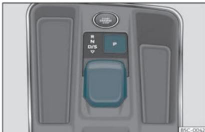
**Fig. 142** Sur la console centrale : levier de sélection.
