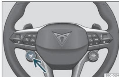
**Fig. 144** Volant multifonction\* : bouton servant à changer le profil de conduite.
