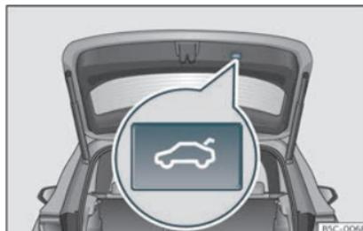
Fig. 82 Hayon : touche de fermeture du hayon
