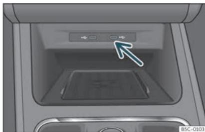
Fig. 136 Console centrale : entrée USB.
