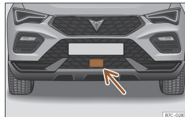
Fig. 101 Dans le pare-chocs avant : capteur radar.
