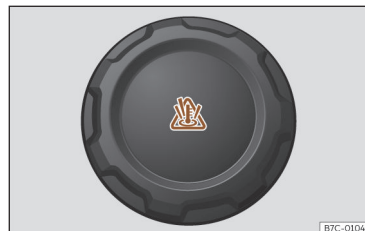
Fig. 194 Compartiment avant : bouchon du vase d'expansion du liquide de refroidissement.
