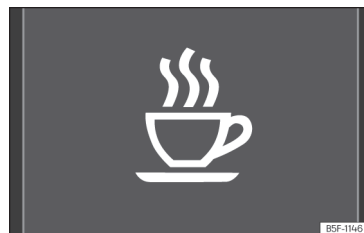
Fig. 5 Sur l'écran du combiné d'instruments : symbole du détecteur de fatigue.
