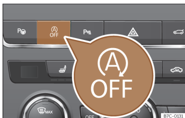
Fig. 91 Console centrale : touche du système Start-Stop.
