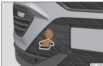
Fig. 183 Du côté droit du pare-chocs avant : retirer le cache.
