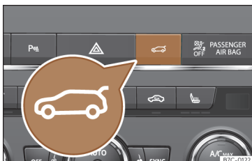
Fig. 56 Console centrale : touche d'ouverture et de fermeture du hayon arrière.
