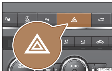
Fig. 40 Combiné d'instruments : interrupteur des feux de détresse.
