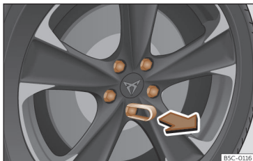
Fig. 207 Roue : boulons de la roue avec capuchons.
