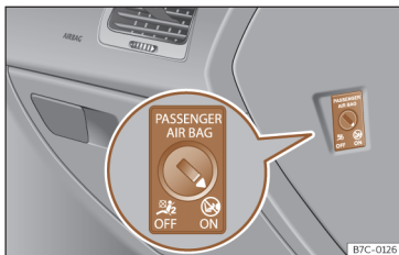
Fig. 25 Commande à clé permettant d'activer et de désactiver l'airbag passager avant.
