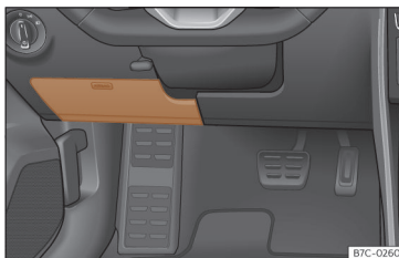
Fig. 187 Sous le combiné d'instruments côté conducteur : couvercle de la boîte à fusibles.
