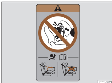
Fig. 34 Autocollant de l'airbag : sur le cadre arrière de la porte du passager avant.
