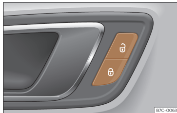
Fig. 49 Sur la porte du conducteur : commande du verrouillage centralisé.
