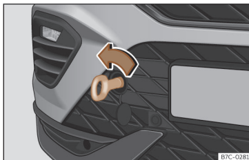
Fig. 184 Partie droite du pare-chocs avant : œillet de remorquage vissé.
