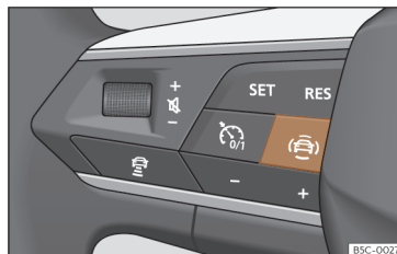
Fig. 100 Côté gauche du volant multifonction : touche pour les systèmes d'aide à la conduite (selon les versions).
