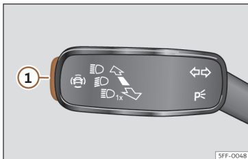
Fig. 99 Dans le levier des clignotants et de feu de route : touche pour les systèmes d'aide à la conduite (selon les versions).
