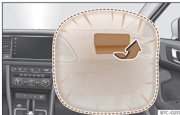
Fig. 24 Airbag du passager avant sur le combiné d'instruments.
