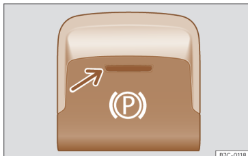
Fig. 124 Dans la partie inférieure de la console centrale : touche du frein de stationnement électronique.
