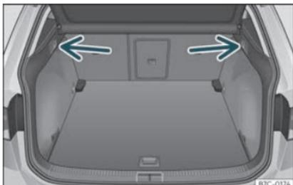
**Fig. 119** Dans le coffre à bagages : crochets pour sacs.
