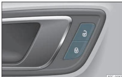
Fig. 75 Porte du conducteur : commande de verrouillage centralisé.
