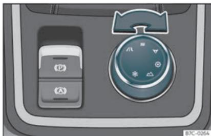
Fig. 146 Console centrale : Commande rotative (Driving Experience button).
