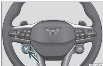
Fig. 147 Volant multifonction\* : bouton servant à changer le profil de conduite.
