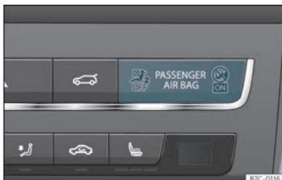
Fig. 16 Planche de bord : témoin de contrôle de la désactivation de l'airbag du passager avant.
