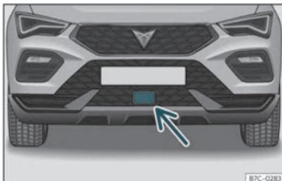
**Fig. 148** Au niveau du pare-chocs avant : capteur radar.
