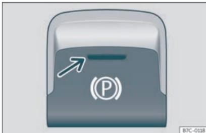
**Fig. 175** Sur la partie inférieure de la console centrale : touche du frein de stationnement électronique.
