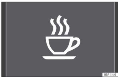
**Fig. 58** Sur l'écran du combiné d'instruments : symbole de détection de la fatigue.
