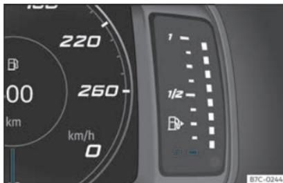
Fig. 60 Indicateur du niveau de carburant.
