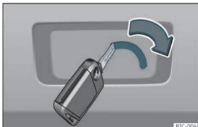
Fig. 87 Détail du coffre à bagages : déverrouillage d'urgence.
