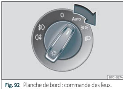
Fig. 92 Planche de bord : commande des feux.
