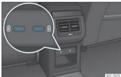
**Fig. 138** Partie arrière de la console centrale : connecteurs USB avec fonction de prise de courant.
