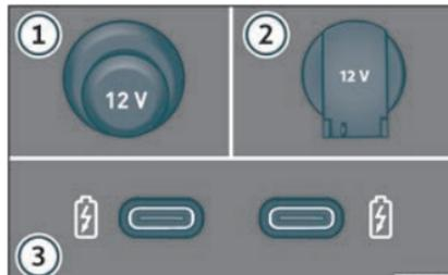
Fig. 127 Prises de courant de 12 volts du véhicule.
