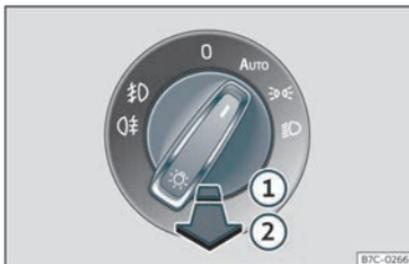
Fig. 93 Planche de bord : commande des feux.
