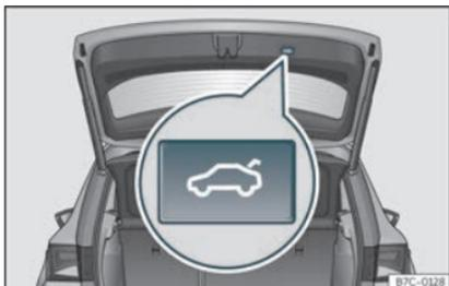
Fig. 83 Hayon : touche de fermeture du hayon
