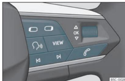
**Fig. 62** Partie droite du volant multifonction : touches permettant d'utiliser les menus et les messages d'information du combiné d'instruments (selon les versions).
