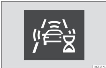
**Fig. 160** Sur l'écran du combiné d'instruments : indication de l'auto-calibrage initial du système.
