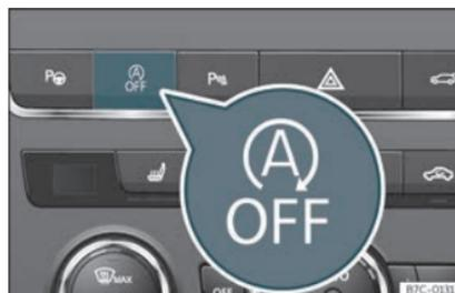
Fig. 141 Console centrale : touche du système Start-Stop.
